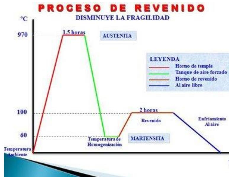
Figura 2 Diagrama de Revenido en general de un material<sup>13</sup>.
