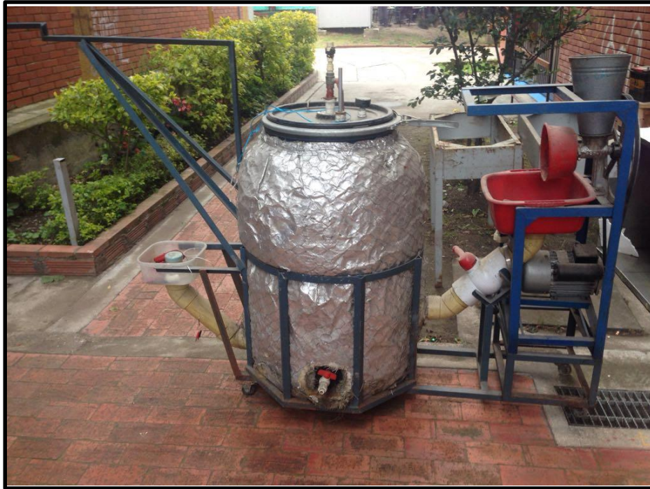
Figura 1. Biodigestor de la facultad tecnológica
