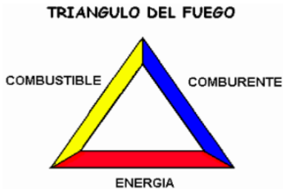
Fig. 6.1.1: Triángulo del fuego. Imagen extraída de Tesis: Diseño del Sistema de Bombeo de agua contra incendio para una instalación petrolera-Cedillo Gómez Israel Jalil [11]
