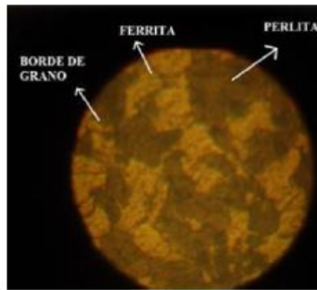
Figura 7. Microestructura interna de los aceros AISI/SAE 1045. [6]
