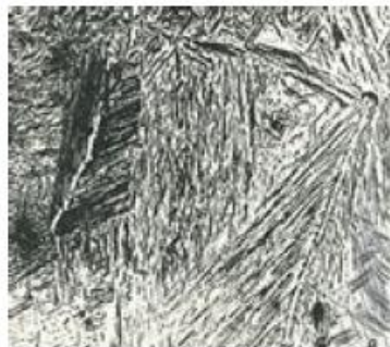
Figura 8. Microestructura de la martensita [6]
