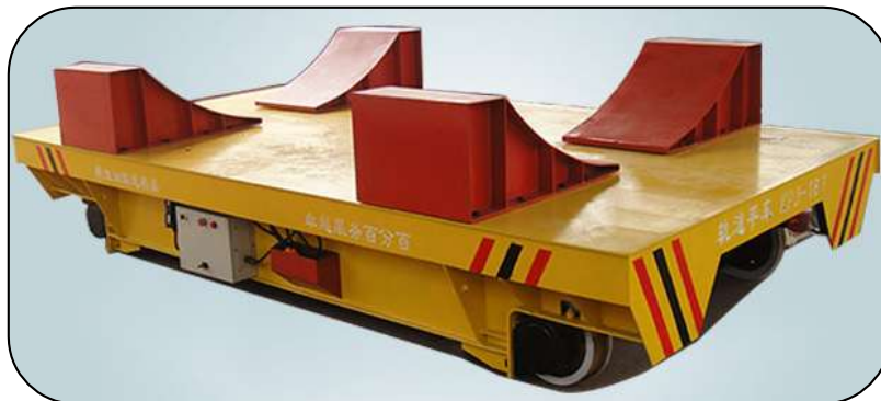
Fig. 8 Carro de transferencia para bobinas KPJ ( http://www.transfer-cart.com/about.php , 01/Abril/2015)
