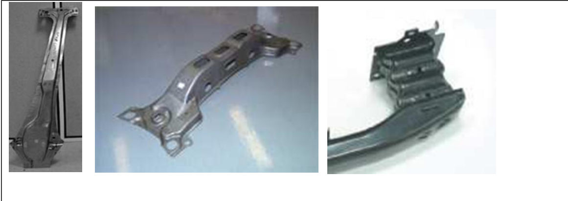
Fig. 1.2- Montantes A, B y aplicaciones de AHSS para absorber impactos.
