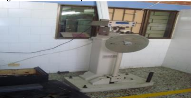
Figura 4. Péndulo de impacto 5A-10700 Satec.
