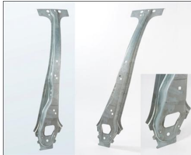
Fig.6 Refuerzo de pie central electrocincado (esp.: 1,2 mm) 4
