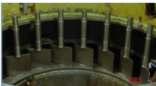
Figura 2. Alabes Móviles de la Turbina Francis Imagen tomada del artículo referenciado a pie de página. p.1
