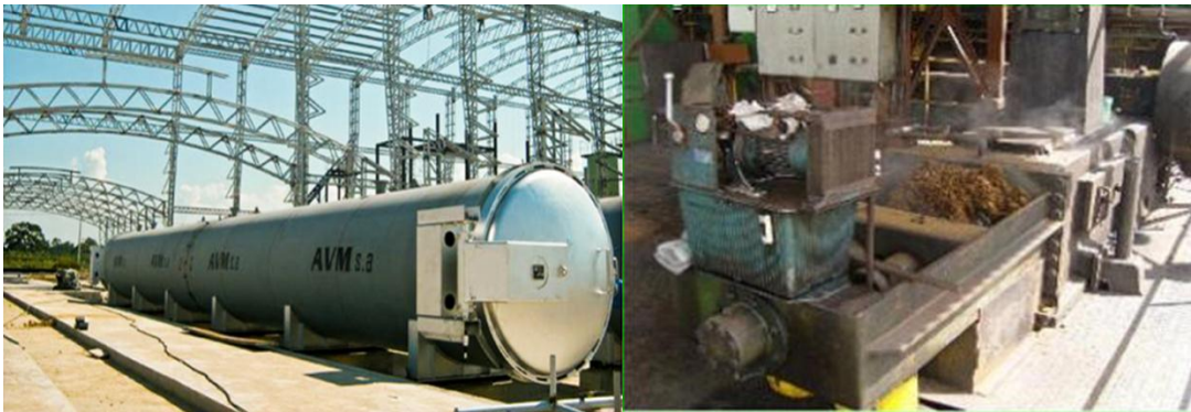
Fig. 3 Fuente: Esterilizador planta palmaceite; industrias AVM Fig.4Fuente: prensa de extracción de aceite; [en línea] ingeniería; http://www.galeon.com ; [consultado] 18/03/2015 Equipos en los que se produce residuos contaminantes
