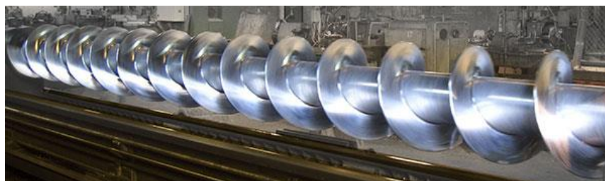
Tornillo sin fin para el manejo de productos a granel.
