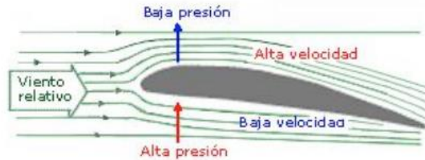
Ilustración 5. Principio de Bernoulli en un perfil alar [tomado de cruz de san Andrés]
