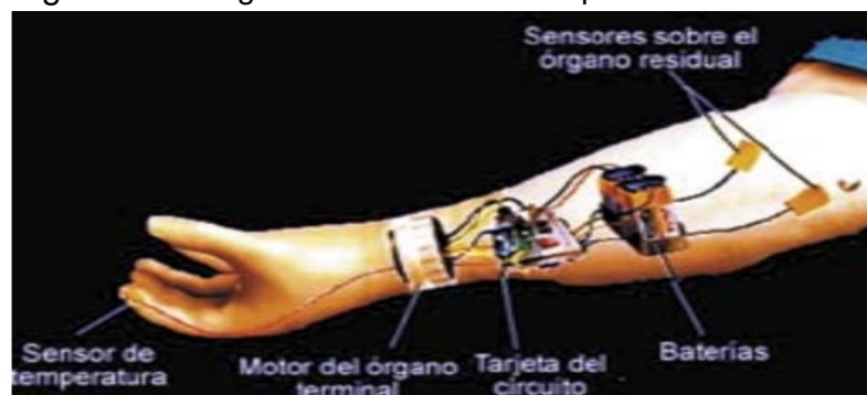
Figura 5: Configuración básica de una prótesis mioeléctrica
