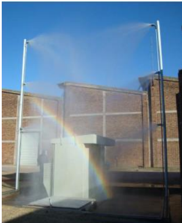
Figura 3: prueba de agua WEG Equipamientos Eléctricos S.A
