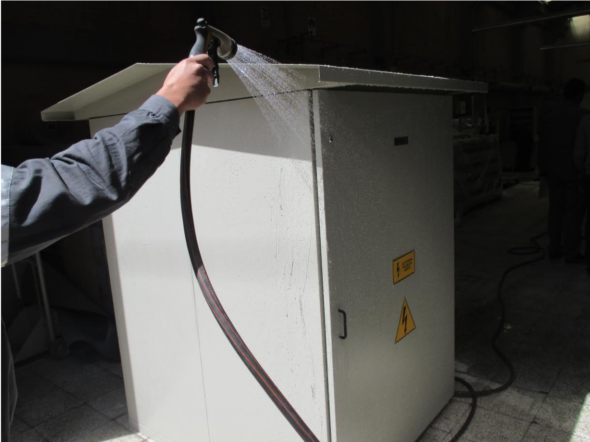
Figura n°2: verificación grado de protección tipo 3R 3
