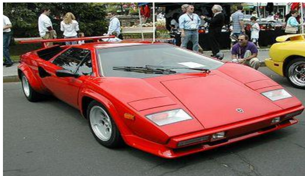
Figura 1.Lamborghini Countach lanzado en 1974.Su forma agresiva posee un coeficiente aerodinámico de 0.42 esto fue pensado para que el viento empujara el coche hacia abajo,
