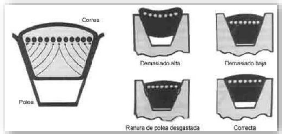
Figura 15. Correas inadecuadas o fallos en las poleas.
