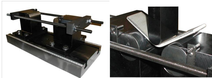
Fig. 1. Dispositivo para doblado guiado con ariete tipo punzón (Tomado de http://www.instron.com.es )
