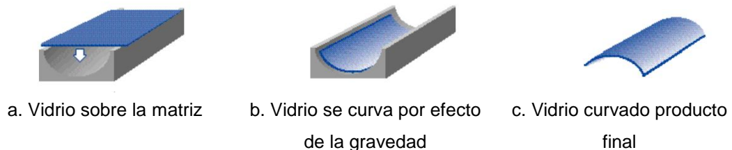
Figura 1: Proceso del curvado del vidrio
