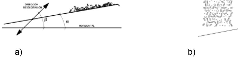
Fig. 4.a) Parámetros geométricos del modelo; b) agrupación de partículas.
