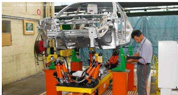
Figura 1: Carrocería de automóviles soportada por FlexPLP.
