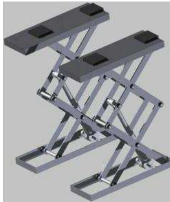
Figura 2: Elevador de doble tijera para vehículos hasta 4 toneladas
