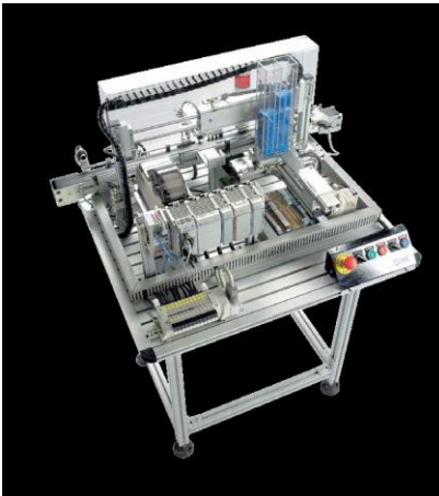
Figura 6. HAS-207 - Colocación de la tapa
