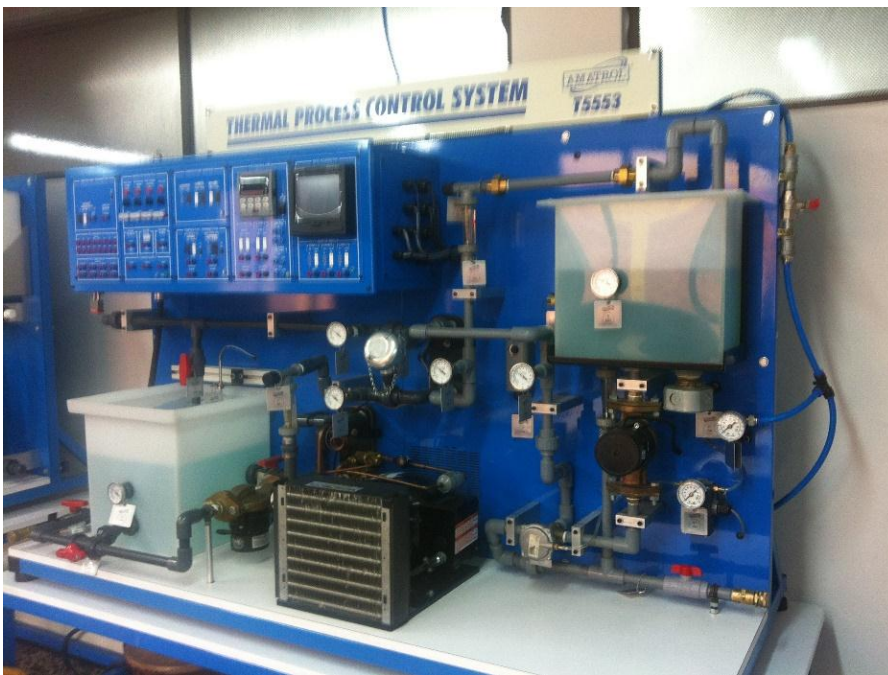
Fig. 1 Planta térmica sistema de control de procesos térmicos de T5553-BD
