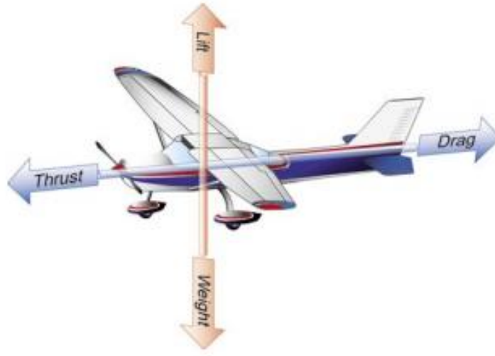
FIGURA 1. LAS CUATRO FUERZAS SOBRE UN AEROPLANO
