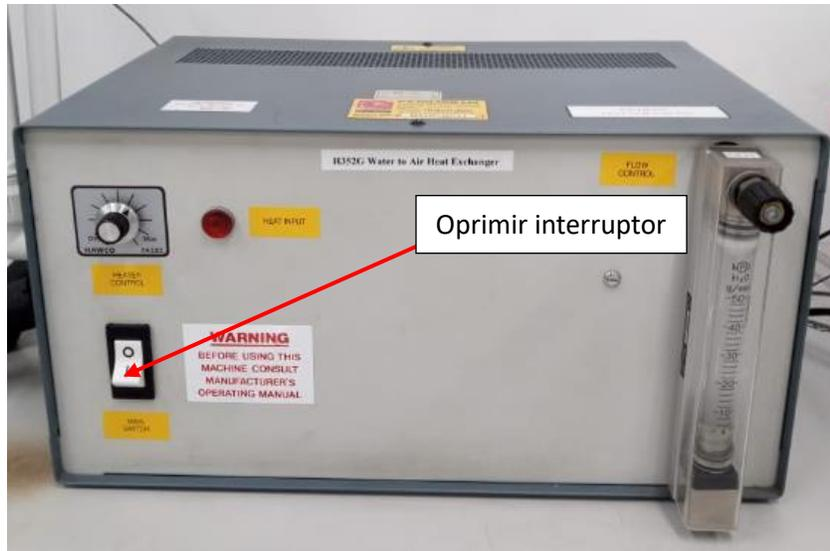
Figura 12. Encendido de bomba.
