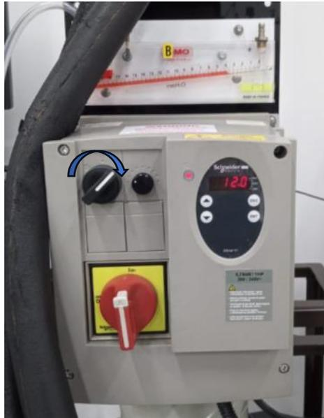
Figura 10. Encendido del ventilador.
