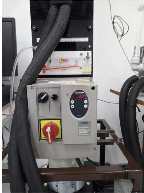
Figura 6. Manómetro y controlador del ventilador.
