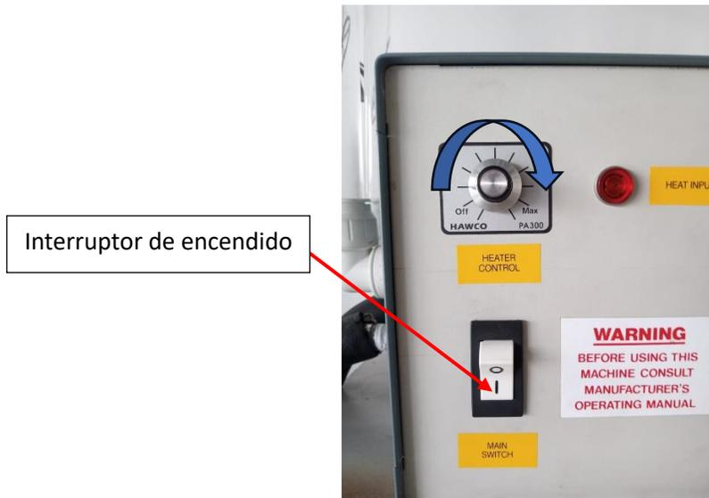
Figura 14. Encendido de resistencia eléctrica.
