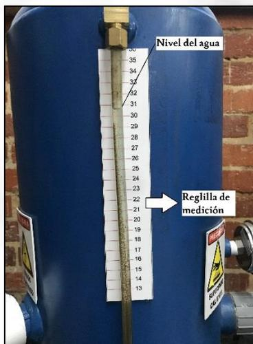
Figura 4. Nivel del tanque
