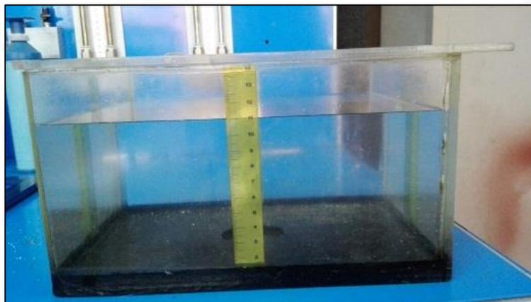
Ilustración 4. Fluido en el recipiente hasta 11 cm de altura.
