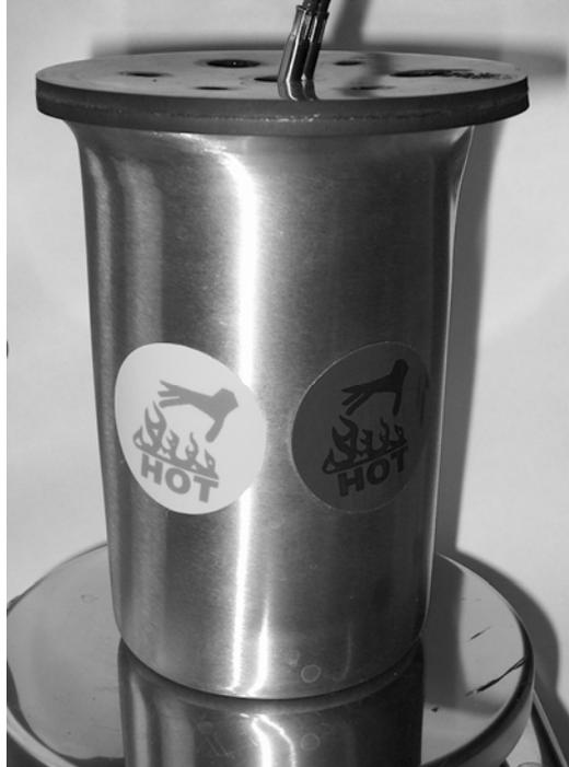
La ventaja de los dispositivos de cristal líquido es que al igual de los mecanismos de expansión (termómetro de cristal) indicadores bi-metálicos, indicador de presión de vapor etc. No necesitan una fuente de energía para funcionar. Sin embargo los mecanismos de cristal líquidos son muy baratos y pueden permanecer fijados en las superficies a estudiar.
