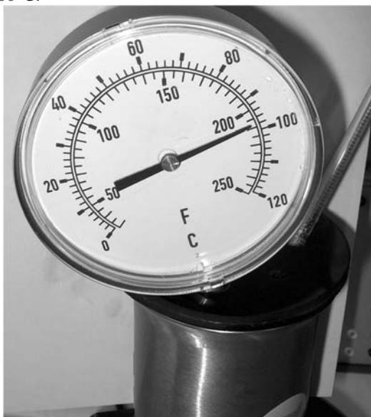
Si el tiempo lo permite se puede repetir este procedimiento con aceite ligero en la bolsa de latón, cuando el termómetro de presión a vapor esta insertado. Está es una práctica normal para ciertas aplicaciones industriales, ya que mejora la precisión de las temperaturas indicadas y también aumenta la velocidad de la respuesta.
