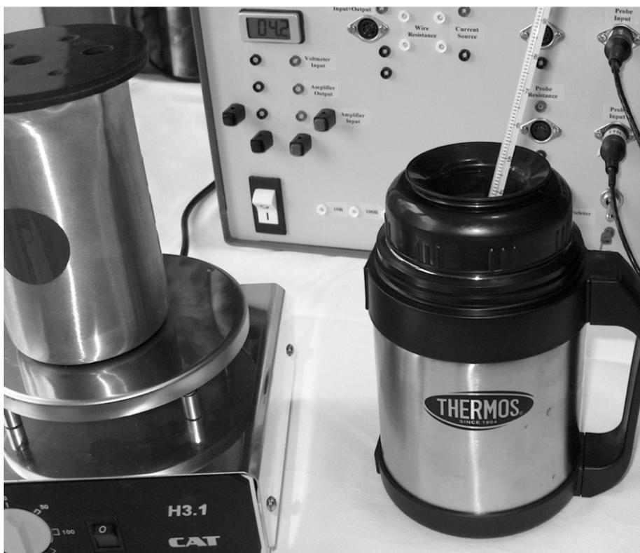
Examinar periódicamente el termómetro en la mezcla agua-hielo y observe la temperatura indicada. Está esta cerca de  $0^{\circ}\text{C}$ .
