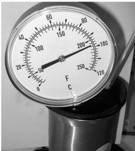
Si el tiempo lo permite se puede repetir este procedimiento con aceite ligero en la bolsa de latón, cuando el termómetro bimetálico esta insertado. Esté es una práctica normal para ciertas aplicaciones industriales, ya que mejora la precisión de las temperaturas indicadas y también aumenta la velocidad de la respuesta.
