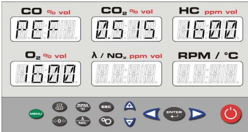
Configure el valor de HC en ppmvol de propano visualizado en el display O<sub>2</sub>:
