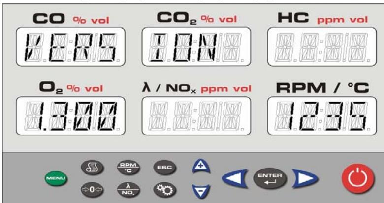
En este menú es posible verificar la versión software (display O<sub>2</sub>) instalada y el checksum (display RPM/°C) del analizador de gases.
