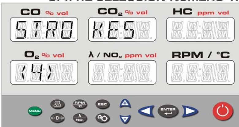
Desde el menú de medición libre pulse y seleccione el número de tiempos del motor con y ; pulse para confirmar y pase al submenú sucesivo.
