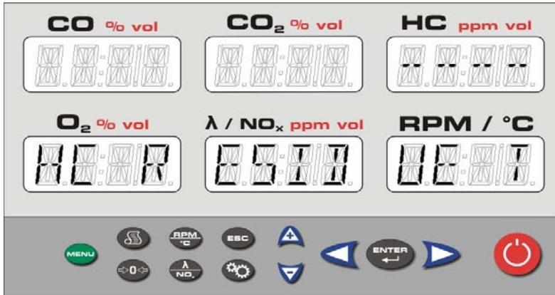
Este menú se utiliza para visualizar la limpieza del circuito neumático del analizador de gases.
