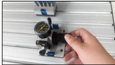
Ilustración 20 Ajuste de presión desde la válvula reguladora
