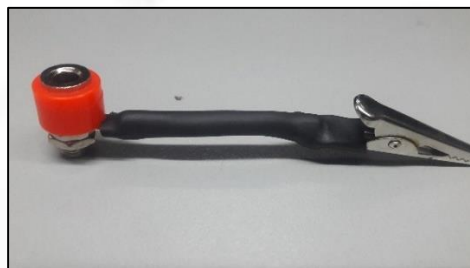
Ilustración 8 Conector Sensor-pinza. Fuente propia.
