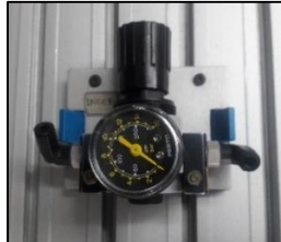
Ilustración 5 Válvula reguladora Festo Ref. 152895. Fuente propia.
