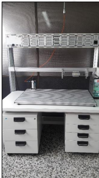
Ilustración 1 Banco neumático Festo. Fuente propia.
