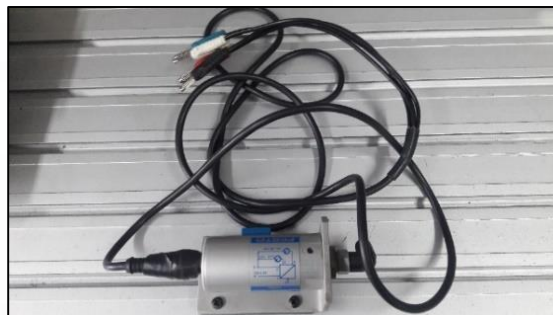
Ilustración 4 Sensor análogo de presión Festo Ref. 184128. Fuente propia.
