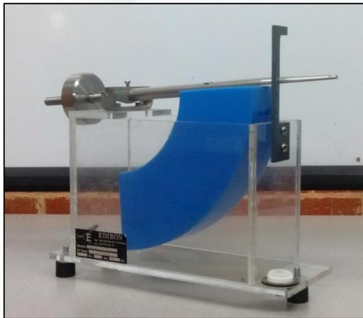
Figura 3. Aparato de presión hidrostática
