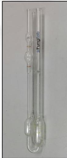
Figura 6. Viscosímetro capilar Oc disponible en el laboratorio (Fuente: Propia)
