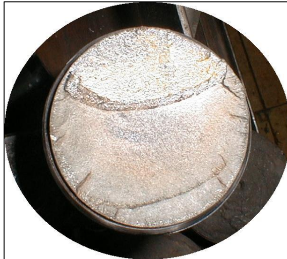
Ilustración 5 Fractura por fatiga de una probeta
