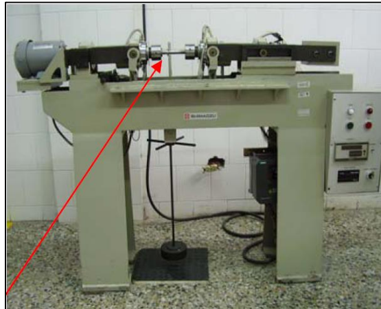
Ilustración 4 Máquina de viga giratoria de alta velocidad de R.R Moore
