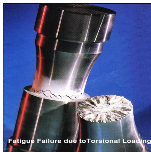
Ilustración 1 Fractura de la probeta por fatiga
