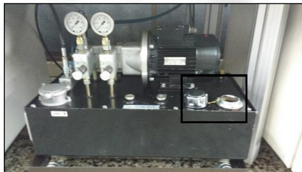
Imagen 14 Bomba Hidráulica (El rectángulo negro indica la apertura del tanque donde se deposita de nuevo el aceite).
