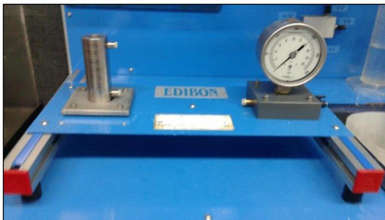
Figura 2. Calibrador de presión peso
