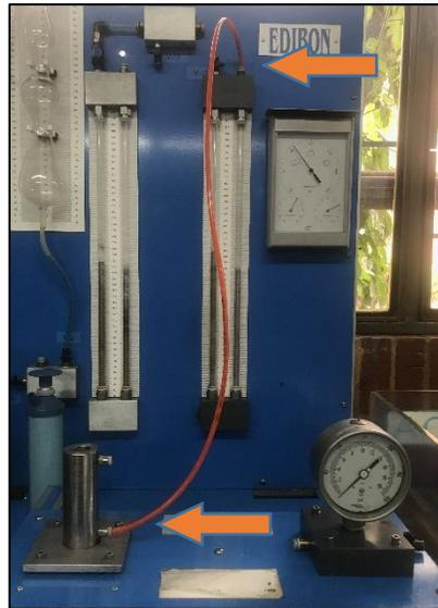
**Figura 9. Conexión cilindro - manómetro**
