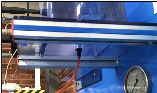
Figura 7. Válvula en posición de cerrado.
