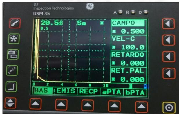
Ilustración 29. Selección de la función BAS y modificación de la función campo
