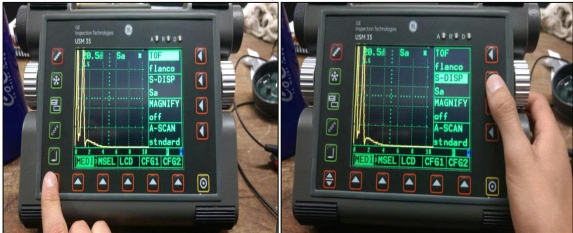
Ilustración 34. Activación de la función Sa
