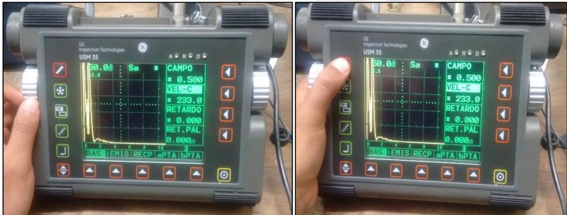
Ilustración 31. Cambio de la ganancia y el paso
