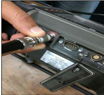
Ilustración 24. Conexión plug al zócalo Lemo Triack de anilla roja (receptor)
