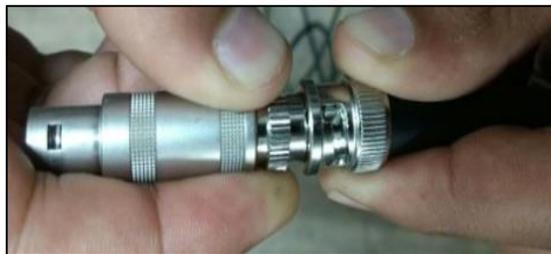
Ilustración 23. Conexión Cable BNC con Plug Lemo-Triack
