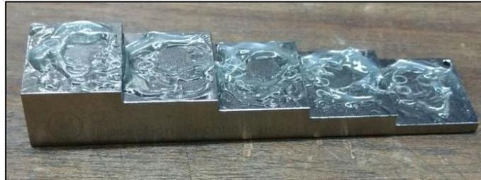
Ilustración 28. Bloque con acoplante (gel)
