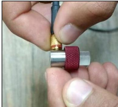
Ilustración 22. Conexión cable BNC al transductor
