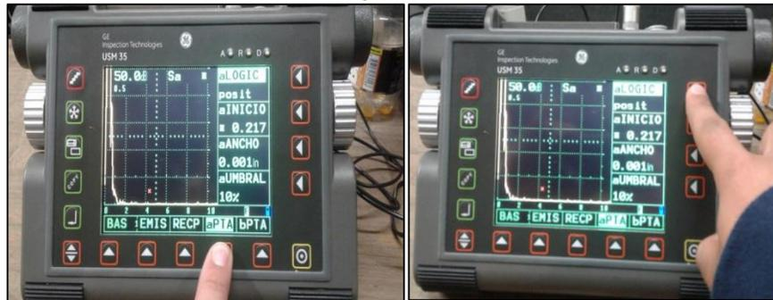
Ilustración 39. Cambio del ajuste de la función aLOGIC.
