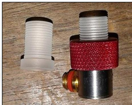
**Ilustración 6. Transductor Alpha-2 15MHz 0.25**
