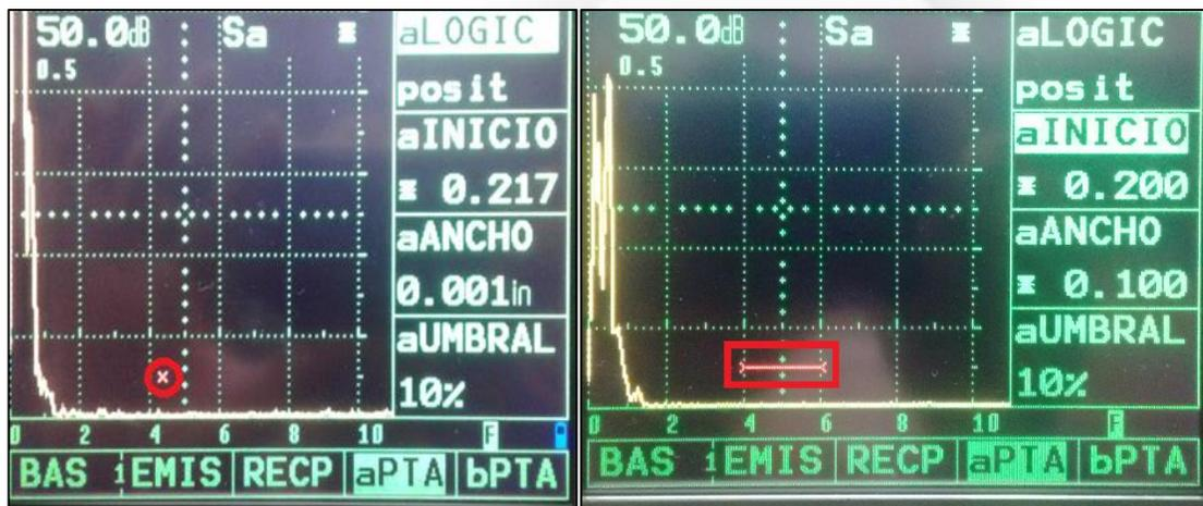
Ilustración 40. Puerta A activa con ajuste posit
