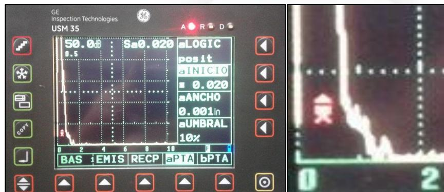
Ilustración 42. Puerta A activando la señal de alarma LED A
