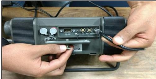
**Ilustración 18. Conexión del cargador**
