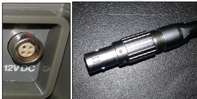
Ilustración 17. Zócalo del ultrasonido y plug del cargador
