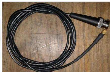
**Ilustración 20. Plug BNC normal**
