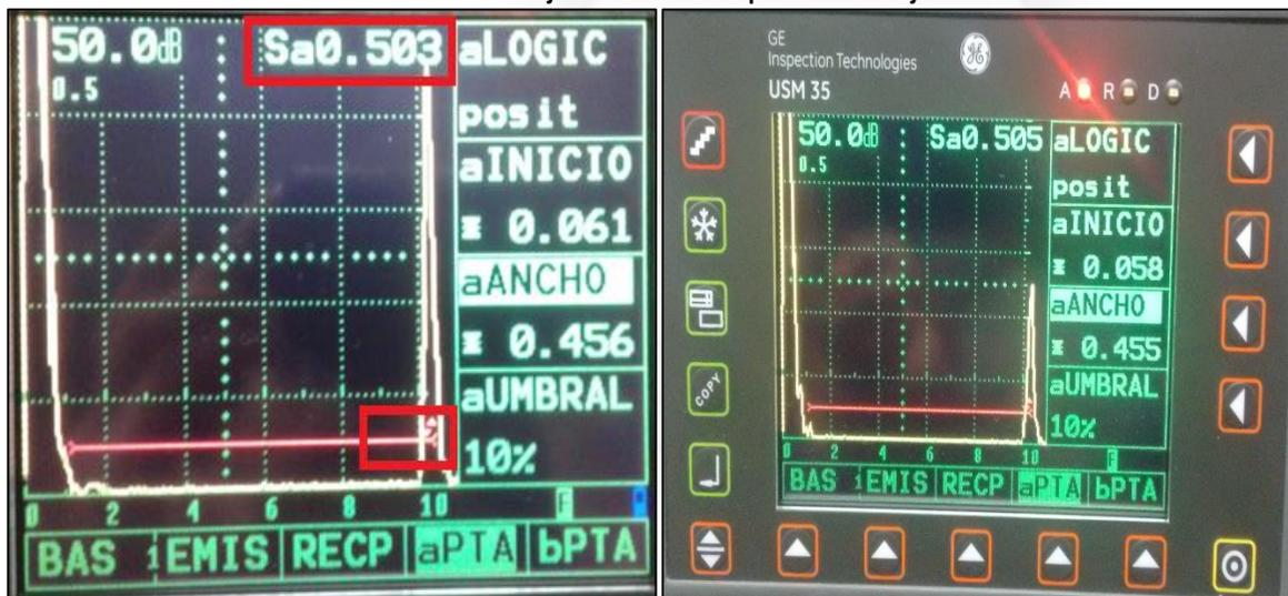
Ilustración 44. Ancho de puerta ajustado a señal del espesor máximo y valor de Sa cercano al máximo
