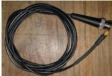
Ilustración 4. Cable BNC normal
