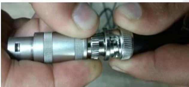
**Ilustración 28. Conexión Cable BNC con Plug Lemo-Triack**
