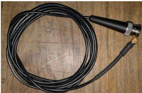
**Ilustración 23. Plug BNC normal**
