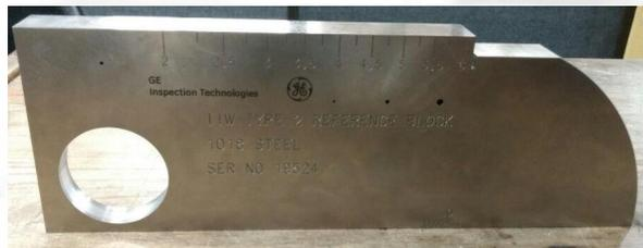
**Ilustración 31. Bloque escalonado para calibración**
