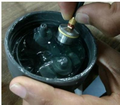
**Ilustración 26. Aplicando gel al transductor**
