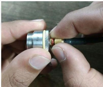
**Ilustración 25. Conexión cable BNC al transductor**
