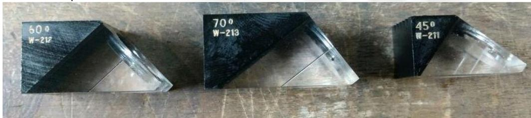
Ilustración 8. Zapatas angulares de 45°, 60° y 70°
