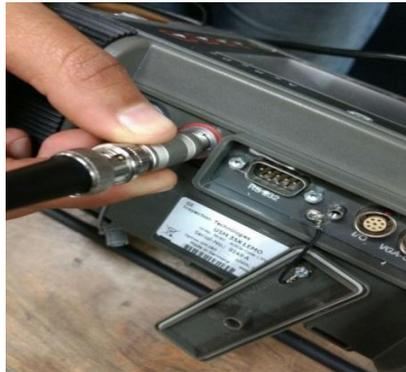
**Ilustración 29. Conexión plug al zócalo Lemo Triack de anilla roja (receptor)**
