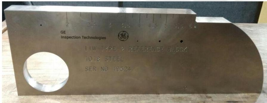
**Ilustración 6. Bloque de calibración tipo 2 IIW**
