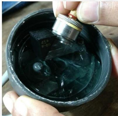
Ilustración 40. Bloque con acoplante (gel)
