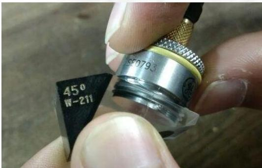
**Ilustración 27. Acoplando el transductor a la zapata**
