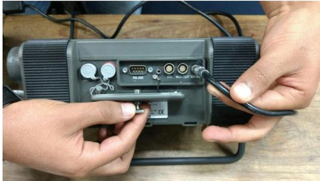
Ilustración 20. Conexión del cargador
