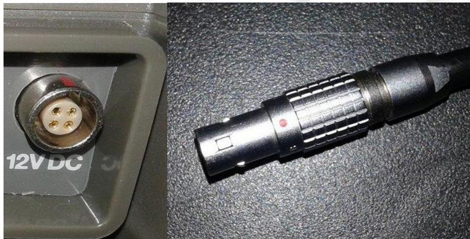
Ilustración 19. Zócalo del ultrasonido y plug del cargador
