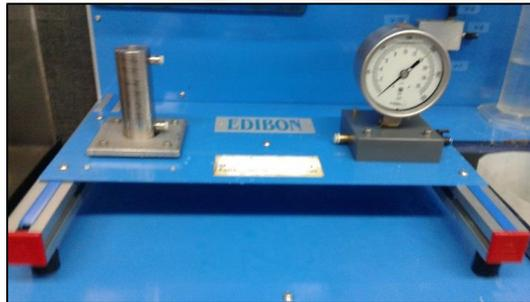
Ilustración 2 calibrador de presión peso muerto
