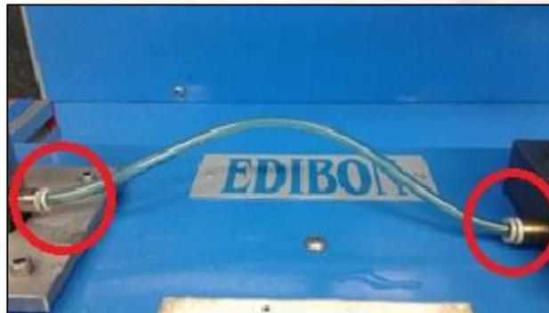
Ilustración 8 conexión cilindro manómetro tipo Bourdon
