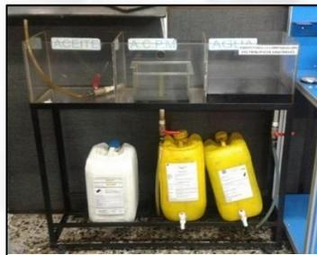
**Ilustración 3. Banco principio de Arquímedes**
