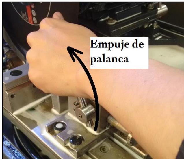
Figura 24 Empuje de la palanca para apretar las mordazas y mantener firme la muestra
