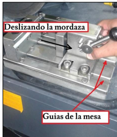
Figura 20 Deslizando la mordaza sobre las guías para mayor apertura
