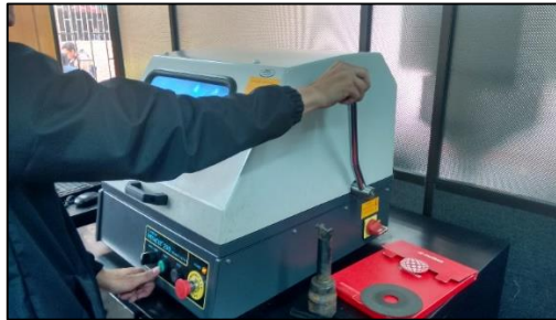
Figura 31 Corte de muestra metalográfica
