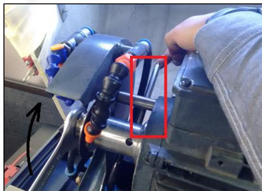
Figura 12 Sentido de giro de la llave inglesa y bloqueo del eje con la llave
