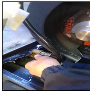
Figura 27 Apertura de la llave de suministro de refrigerante
