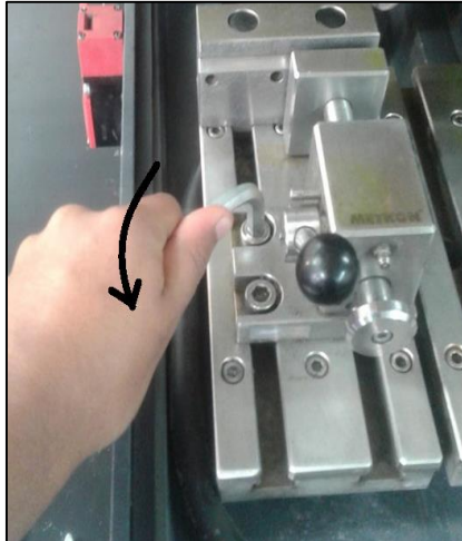
Figura 19 Desajuste del tornillo en sentido horario
