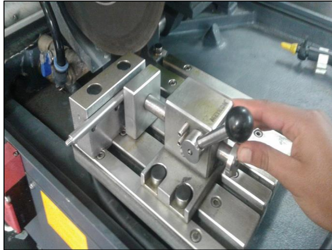
Figura 23 Empuje de mordazas contra la muestra utilizando el émbolo
