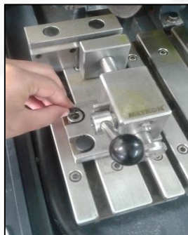
Figura 18 Retirando tapones de los tornillos de sujeción de la mordaza
