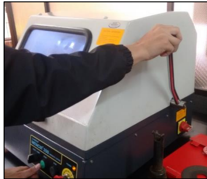
Figura 33 Retorno de la palanca a su posición inicial
