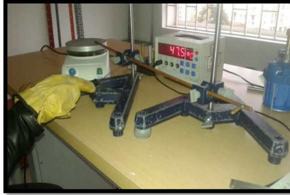
Figura 4. Medición de la temperatura en uno de los puntos marcados en la varilla de cobre usando la estufa como fuente de calor
