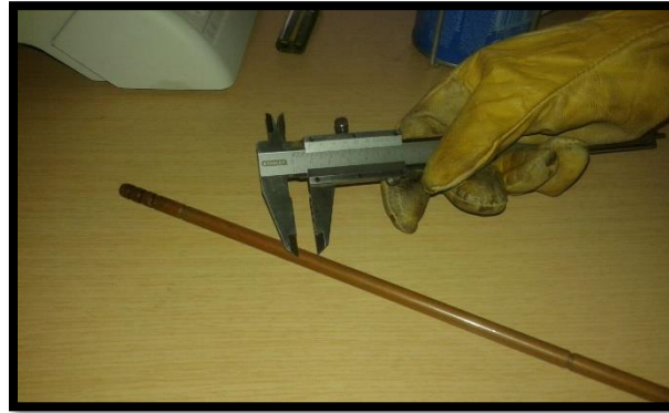
Figura 1. Medición de la longitud y el diámetro de las varillas
