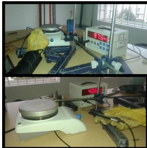
Figura 5. Mediciones de temperatura en la varilla de aluminio usando la estufa como fuente de calor.
