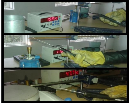
Figura 2. Montaje experimental con tres fuentes de calor: recipiente con agua caliente, mechero y estufa
